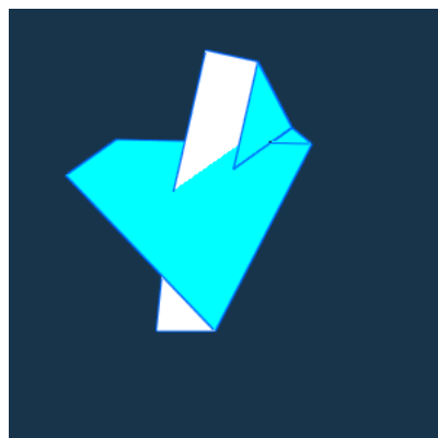
図 4.4: 面の交差が生じている例
